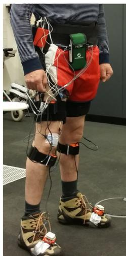
**Bild 4** Sensorausstattung der Spastikmessung im Labor. XSens MVN Biomch Motion Capturing Anzug, Noraxon Labor-EMG, NASFIT EMG-Prototyp
