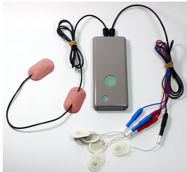
**Bild 2** Messhardware bestehend aus Basisgerät, zwei in Silikon eingegossene Inertialsensorboards (rosa) und EMG-Elektroden
